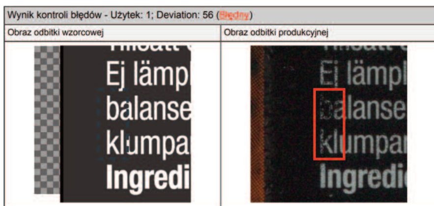
PRZYKŁADOWE BŁĘDY WYKRYTE PRZEZ SYSTEM PROOFILER 600 DT W DRUKARNI A-Z COLOR
